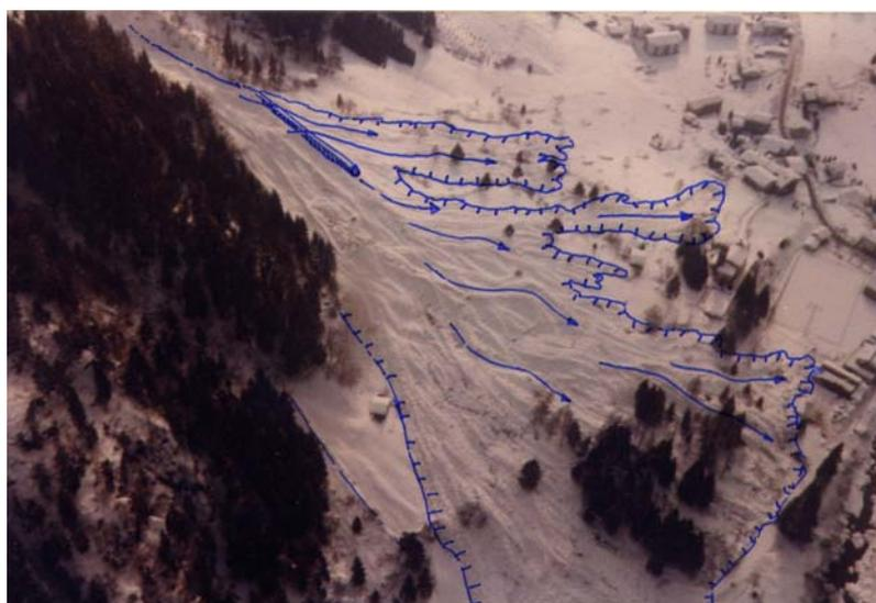
**Figura H.6 -** Ripresa aerea dell'evento del 31/1-01/2 1986, con indicazione del limite del deposito
