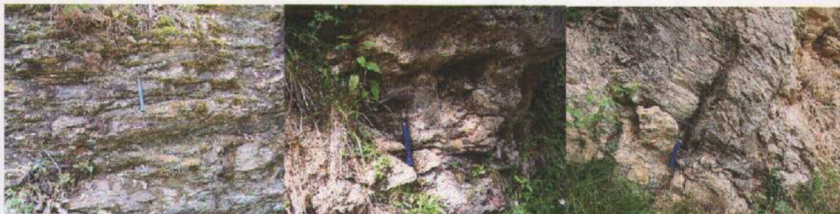
Foto 73 Facies tipica degli Scisti Mangesiferi (Località Villa Oneto) Foto 74 .intercalazioni di calcari neri in argilliti grigio scure (Località Campodonico) Foto 75 Aspetto tettonizzato dei livelli carbonatici in prossimità del contatto con l'Unità dell'Antola (località P.ta Anchetta)
