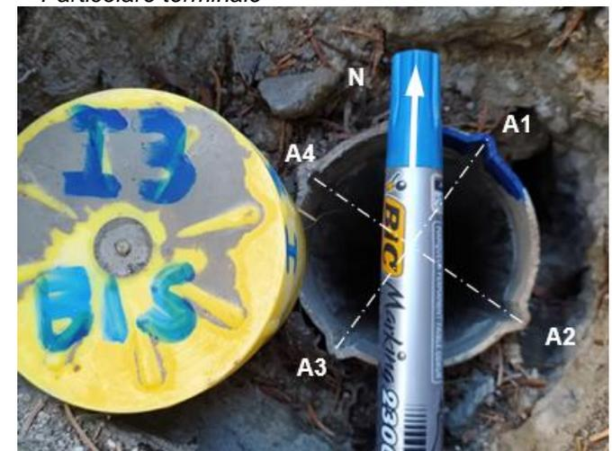
Note: lettura di zero manuale eseguita il 18.01.2022 previa installazione di sonde fisse alla profondità compresa tra -15.9 m e -20.1 m. Prima acquisizione alla profondità di 28.5 m – passo 0.5 m – sonda S060314
