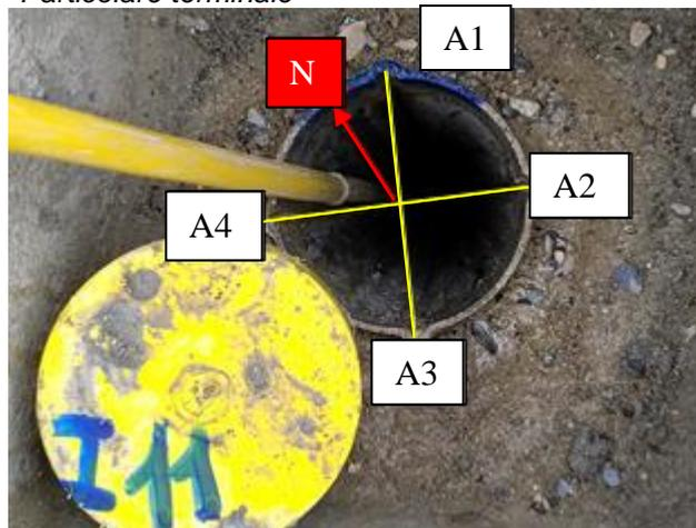
Note: lettura di zero eseguita il 12.05.2022. Prima acquisizione alla profondità di 24.00 m – passo 0.5 m – sonda S060314. L'inclinometro si trova all'interno di un terrazzamento con accesso da cancello privato ed è ubicato al confine di valle con la Strada Provinciale (SP25) che porta alla chiesa di Ville S. Pietro. L'inclinometro I11 è associato al piezometro P11 installato a circa 5 m di distanza, alla medesima quota.
