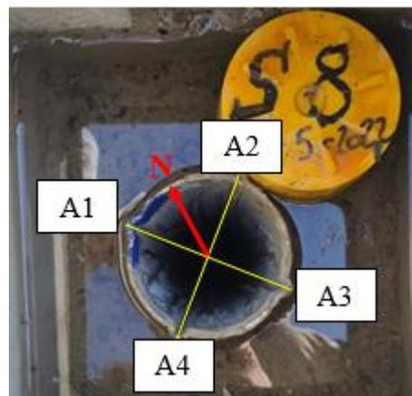
Note: prima acquisizione alla profondità di -32,50 m - passo 0,5 m - sonda S091260
