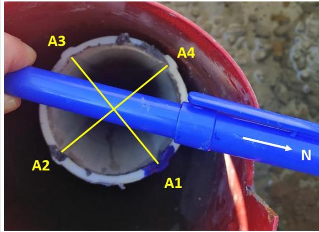
Note. <sup>1</sup> Prima acquisizione strumentale a profondità -15 m; P= 1,0m – sonda S091260
