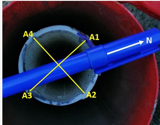
Note. <sup>1</sup> Prima acquisizione strumentale alla profondità di -20 m; P=1,0m – sonda S091260
