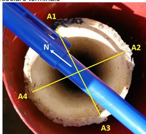
Note. <sup>1</sup> Prima acquisizione strumentale a -17m ; P=1,0m – sonda S091260
