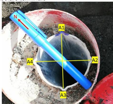
Note. <sup>1</sup> Prima acquisizione alla profondità di -23,50 m - Passo 0,5m – sonda S091260
