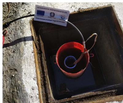
Note: Falda : prima misura -1,43m (Progetto AD VITAM). Installazione sonda freaticometrica automatica POR in data 22/01/2019 (AD VITAM / REMOVER).
