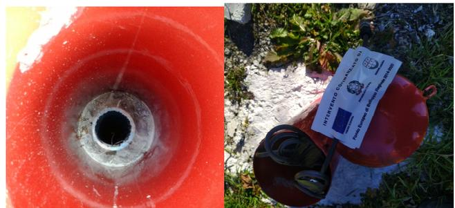
Note. Prima lettura falda a – 3,70m. Installazione sonda freaticometrica automatica 13/02/2019
