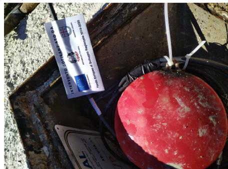
Note: prima misura di falda a -6,76m . Installazione sonda freaticometrica automatica in data 12/02/2019.
