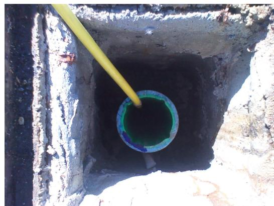
Note. Inclinometro monitorato con la lettura di zero del 04/08/2014. Profondità di misura 14.5m. Classificato funzionante dal professionista (Geol.R.Macciò).
