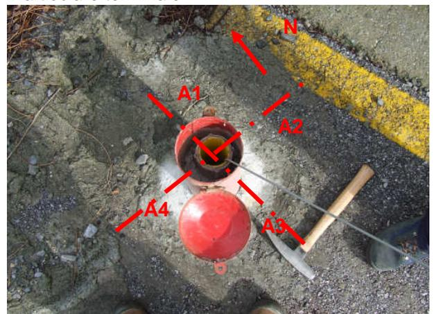
Note. <sup>1</sup> Lunghezza misurata 24 m. <sup>2</sup> La tubazione inclinometrica in alluminio risulta condizionata all'interno da un'altra tubazione in ABS di diametro inferiore.
