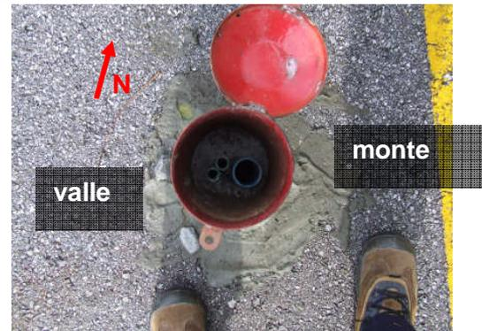
Note. <sup>1</sup> Lunghezza del piezometro a tubo aperto misurata 21 m; lunghezza del piezometro tipo Casagrande misurata 23,60 m. <sup>2</sup> Il diametro del tubo aperto è 1,5 "; il diametro dei tubi Casagrande è 0,5 ".
