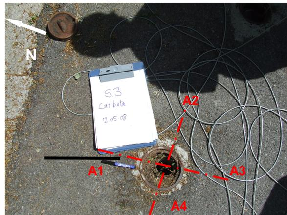
Note: Inutilizzabile, per la presenza a -23,15 m di deformazione non superabile dalla sonda.
