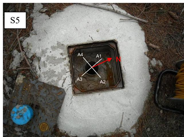
Note: prima acquisizione alla profondità di -43,0 m – passo 0,5 m – sonda S222643
