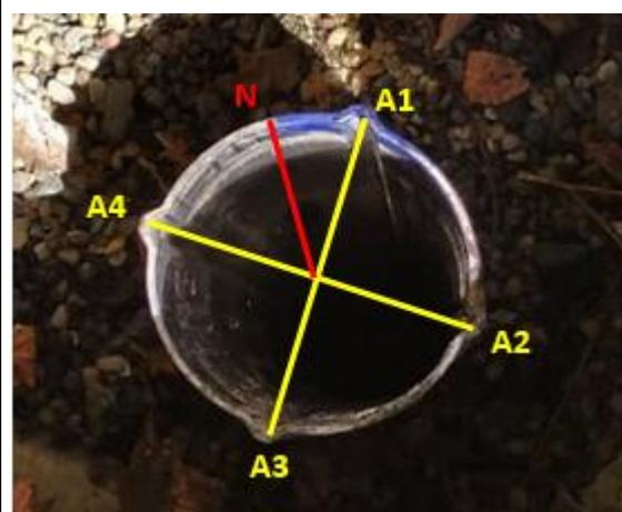
Note: Lunghezza tubo 24,0 m, prima acquisizione alla profondità di -23,5 m – passo 0,5 m – sonda S091260
