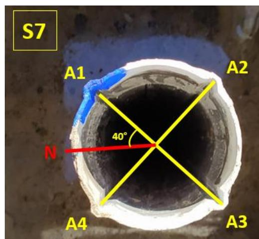
Note: Lunghezza tubo 26,5 m, prima acquisizione alla profondità di -26,0 m – passo 0,5 m – sonda S091260
