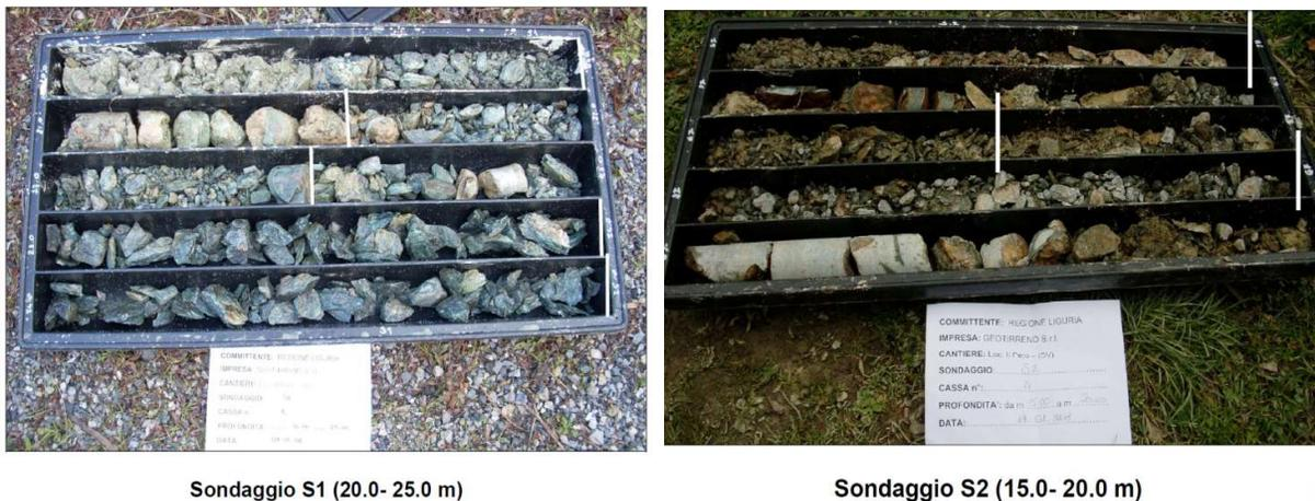
**Fig. 3** - Colonne stratigrafie di S1 (IP1) e S2 (IP2) caratterizzate da serpentinoscisti e metabasiti, con importanti livelli di cataclasi
