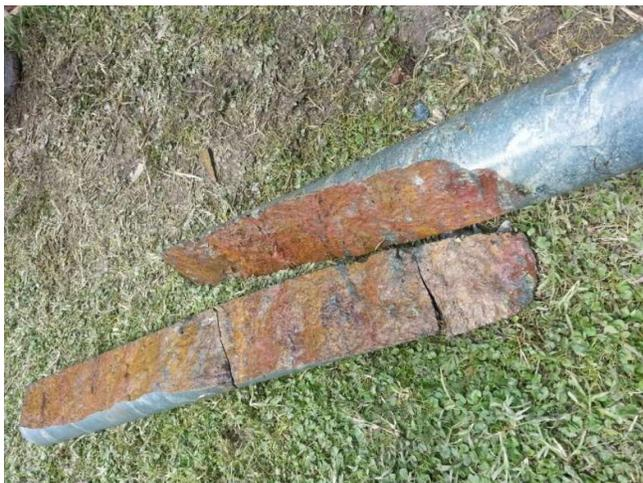
**Fig.6** - Il set di fratture trasversali alla scistosità seziona in senso longitudinale le carote: l'alterazione dei piani di frattura è elevata con presenza di deboli ricristallizzazioni sulla superficie che appare debolmente ondulata e con gradini di scorrimento. Tali fratture, insieme alle discontinuità sub orizzontali, sono indiziate di essere le responsabili dello scivolamento della frana.
