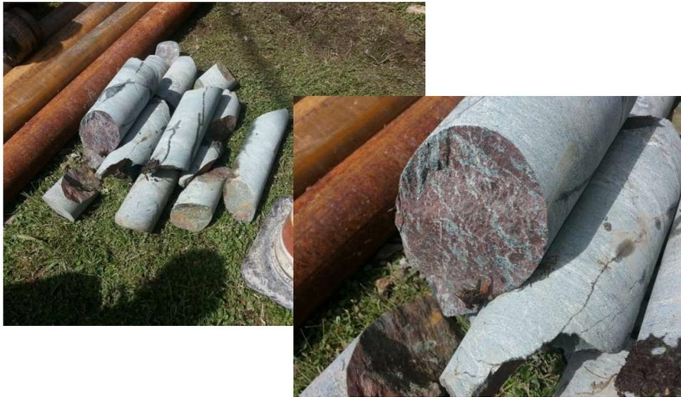
**Fig.5** - Intervallo 34-36 m del basamento roccioso: carote di metabasiti ed evidenti discontinuità sviluppate lungo i piani di scistosità, che nelle zone ove la trasposizione è meno evidente coincidono con i fianchi delle shear folds. La superficie delle fratture risulta ossidata in modo pressoché totale e tali discontinuità aperte contribuiscono alla debolezza del substrato roccioso in termini di stabilità.
