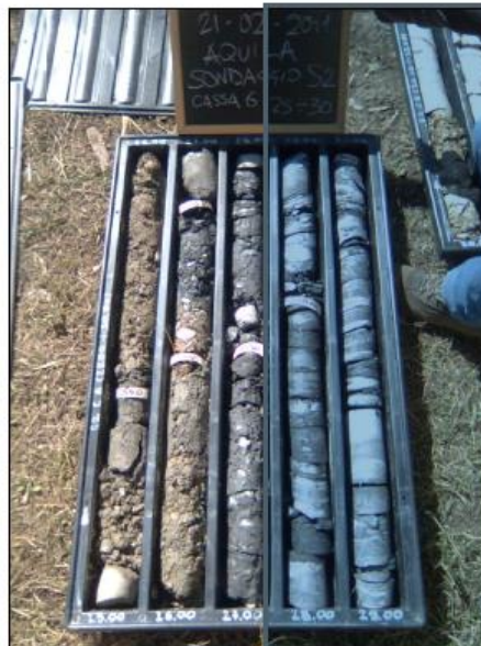
Foto n.7 Materiale carotaggio S2 tra 25.0-30.0 m
