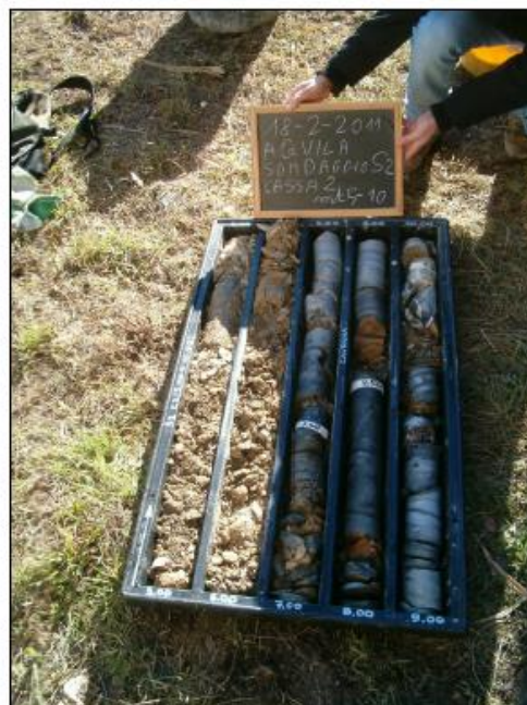
Foto n.3 Materiale carotaggio S2 tra 5.0-10.0 m
