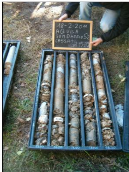
Foto n.7 Materiale carotaggio S2 tra 25.0-30.0 m
