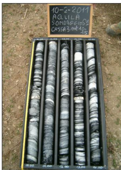
Fig. 2 – Calcari e marne calcaree presenti a -3 m di profondità in S1 (valle).
