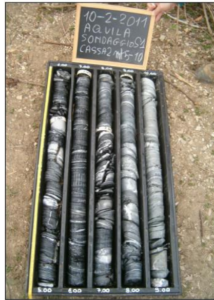
Foto n.6 Materiale carotaggio S1 tra 15.0-20.0 m
