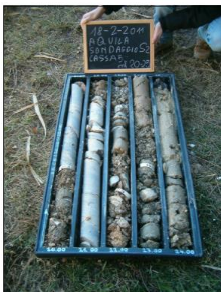
Foto n.6 Materiale carotaggio S2 tra 20.0-25.0 m
