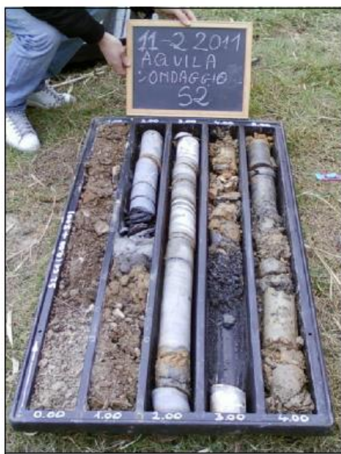
Foto n.2 Materiale carotaggio S2 tra 0.0-5.0 m
