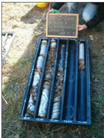
Foto n.6 Materiale carotaggio S2 tra 20.0-25.0 m
