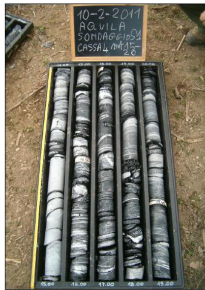
Fig. 2 – Calcari e marne calcaree presenti a -3 m di profondità in S1 (valle).
