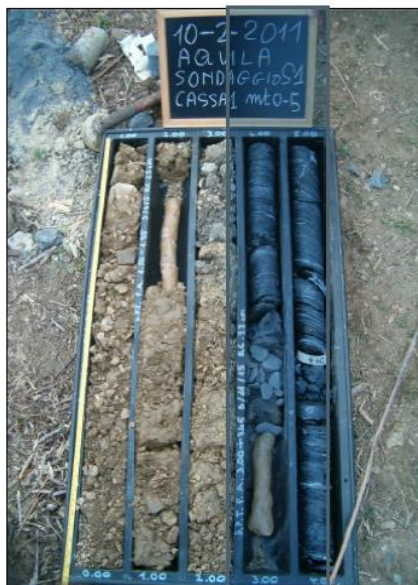
Foto n.5 Materiale carotaggio S1 tra 10.0-15.0 m
