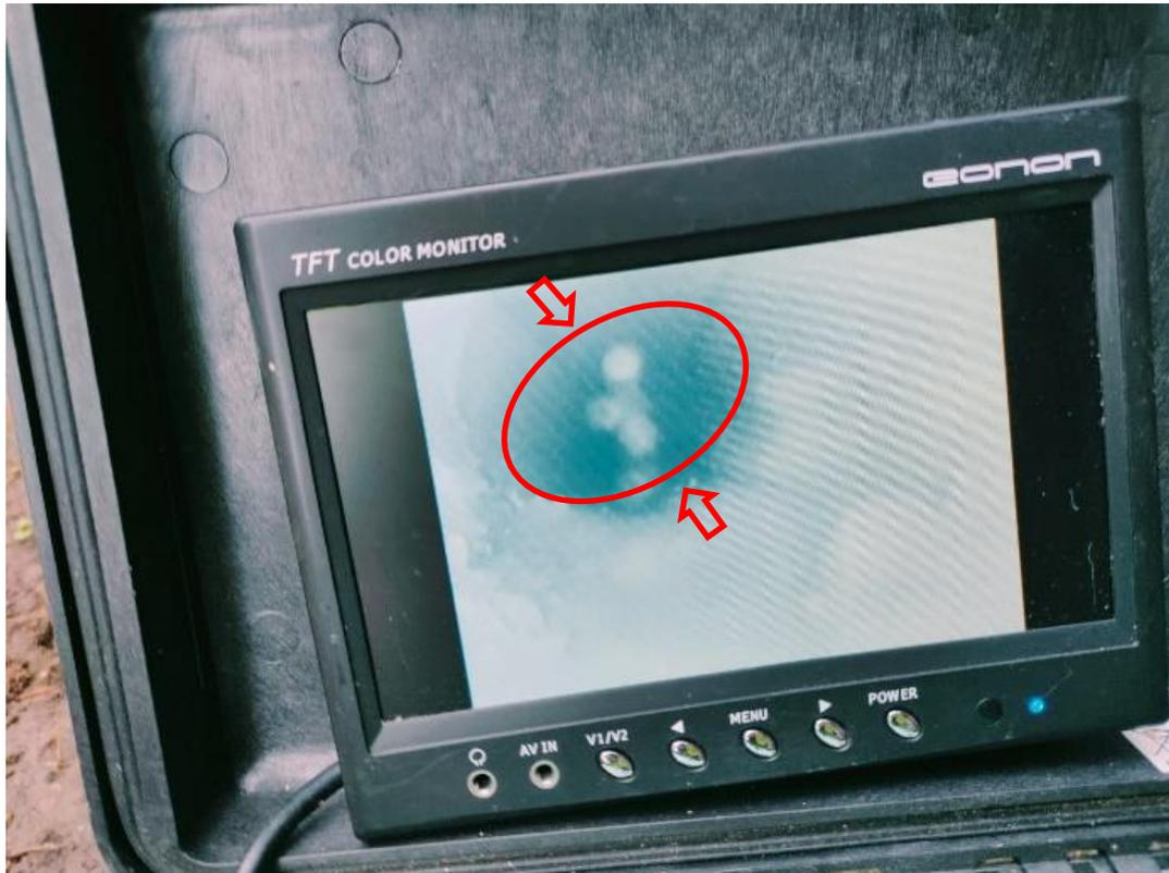
**Fig. 13** – Immagine tratta dalla videoispezione in foro relativa a I3 (2021). Le frecce rosse indicano la strozzatura del tubo determinata dalla deformazione registrata nel corso degli anni dalla tubazione inclinometrica nella fascia tra -17 m e -19 m dal piano campagna.
