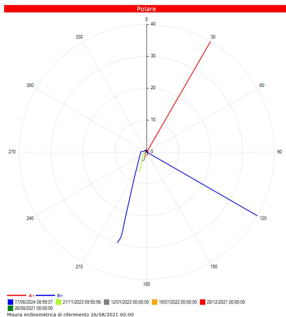
Fig. 9 - Grafico relativo all'elaborazione differenziale integrale (diagramma polare della deviazione) dell'inclinometro S8.
