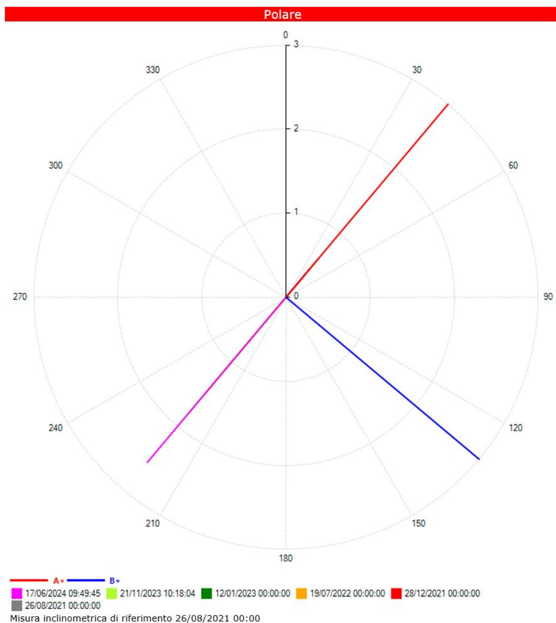
Fig. 7 - Grafico relativo all'elaborazione differenziale integrale (diagramma polare della deviazione) dell'inclinometro S7.
