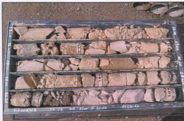
Fig. 2 - Basamento roccioso da 20 a 30 m, profondità di installazione dell'inclinometro S1: si osservi la frammentazione del litotipo calcareo dovuta alla presenza nell'area di importanti lineamenti tettonici.
