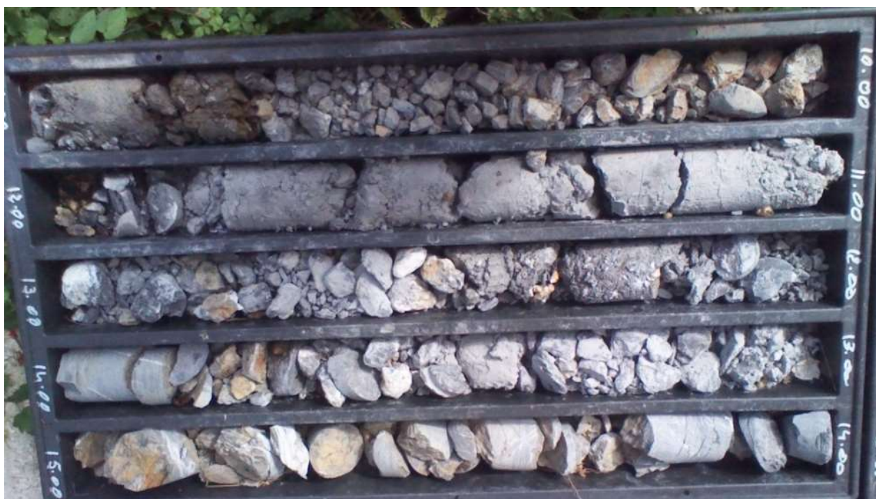
Fig. 14 - Intervallo 10-15 m del sondaggio eseguito alla base dell'edificio: si noti la natura fortemente granulare del materiale e l'inizio del basamento roccioso disgregato.
