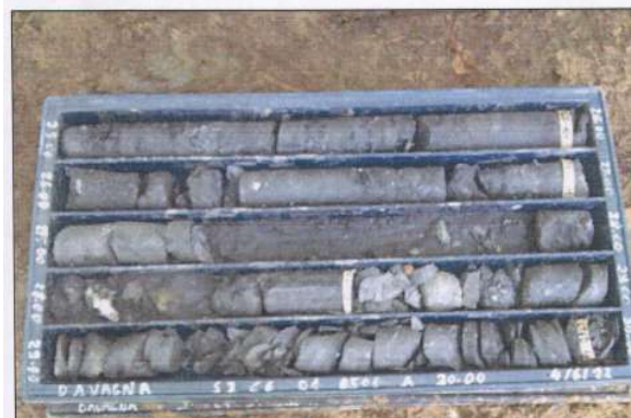
Fig. 3 - Basamento roccioso da 20 a 30 m, profondità di installazione dell'inclinometro S2: si osservi la frammentazione del litotipo a componente marnosa dovuta alla presenza nell'area di importanti lineamenti tettonici.
