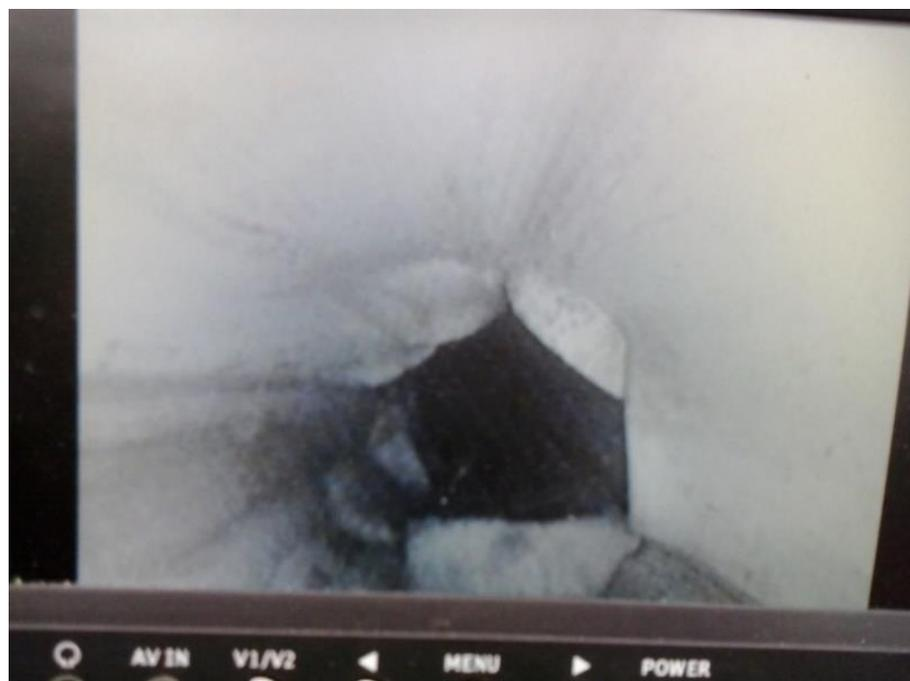
**Fig. 12** - Forte deformazione con piano di taglio a -20 m nell'inclinometro S6
