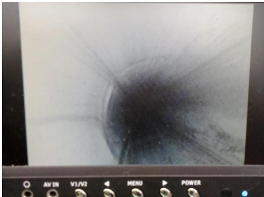
**Fig. 11** - deformazione a -16m nell'inclinometro S6
