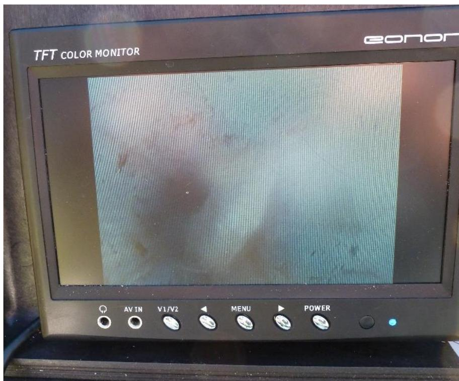
**Fig. 8** - Inclinometro S7. Anche in questo caso la foto mostra la presenza di pietrame all'interno della tubazione alla profondità di -8.6m: le pietre ostruiscono completamente l'interno della tubazione che pertanto non risulta più utilizzabile.
