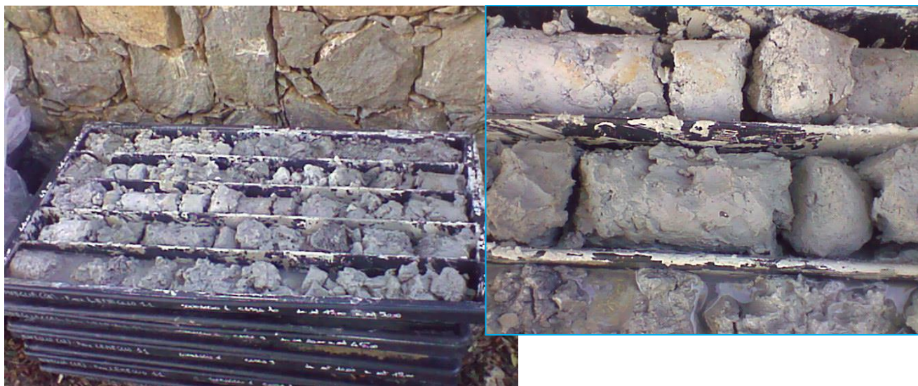
Fig.21 - Cassette catalogatrici presenti sul piazzale accanto a S15 e particolare della zona di scorrimento tra -45 e 50m
